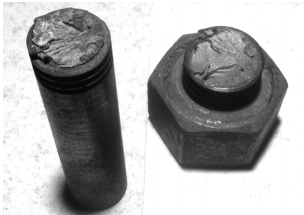
Figura 2. Plano de falla del bulón colapsado A.
